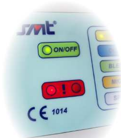
indikace zapnutí přístroje (zeleně nahoře) a dvojitá varovná indikace špatně zapojené nebo poškozené pacientské neutrální elektrody (červeně)
