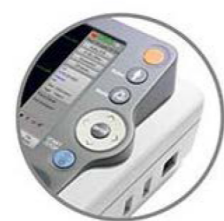
15° sklon displeje pro snadné odečítání výsledků
